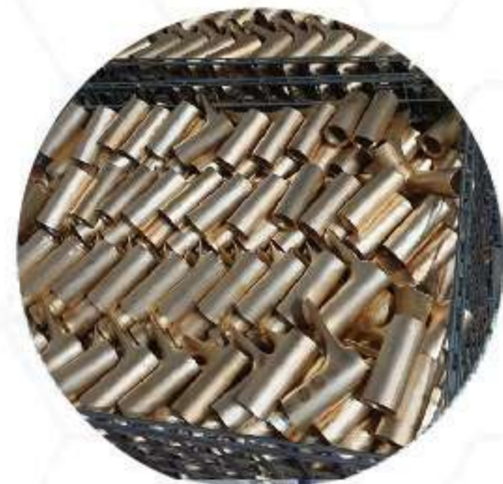
Tạo phôi bằng máy đúc áp cao và máy CNC
