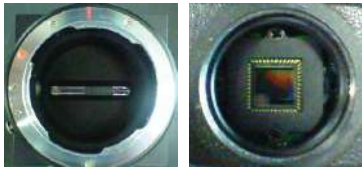
Một dãy gồm 64 điểm cảm ứng ở vòi LINE SENSOR
